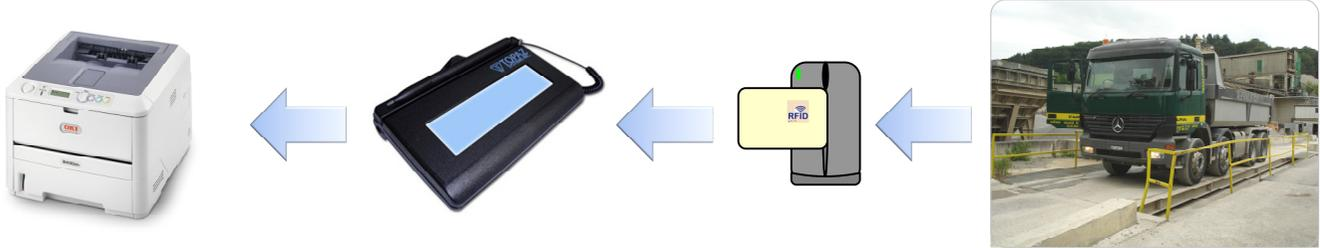
Sortie par le pont de pesage, identification au moyen de la même carte RFID, récapitulatif du chargement, signature électronique et impression du bulletin de livraison. Une copie peut-être imprimée simultanément au bureau de la gravière.
